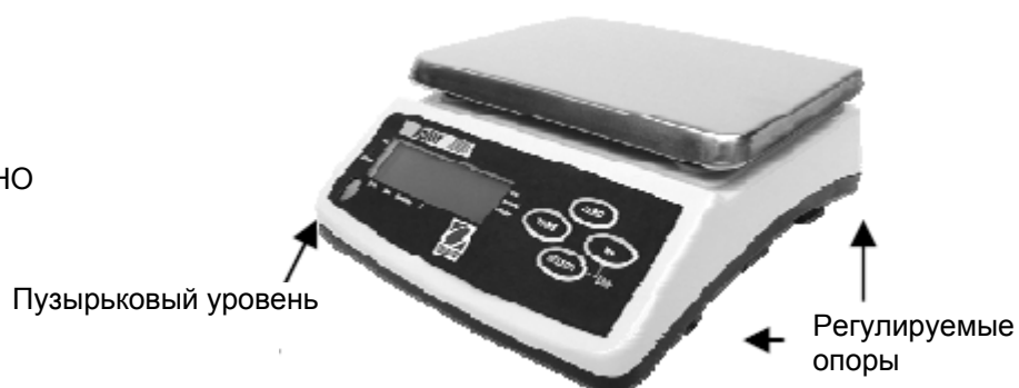
Рис. 2-1. Выравнивание весов в горизонтальной плоскости.
