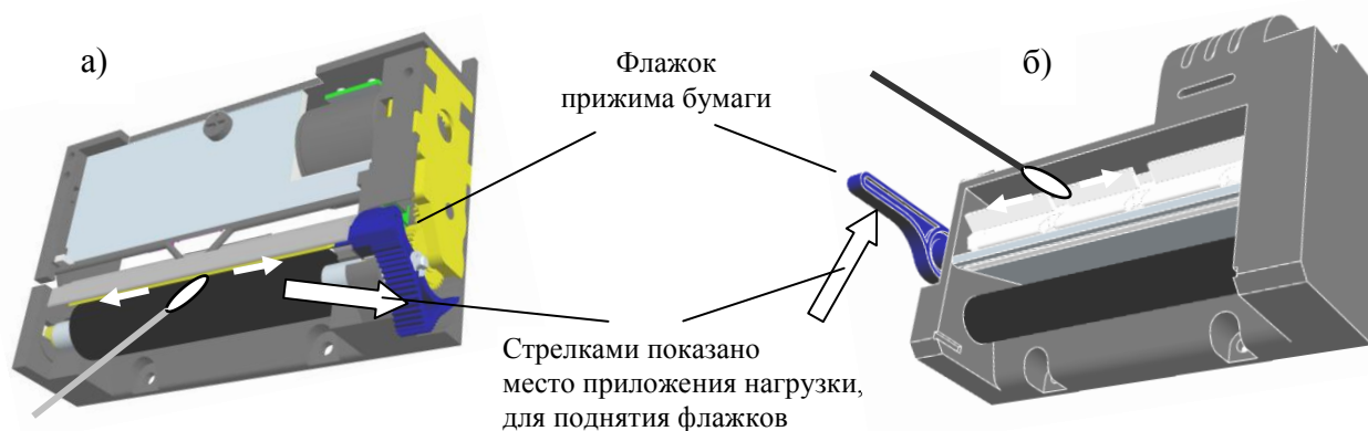
Рис. 28 - Чистка термоголовки принтера
