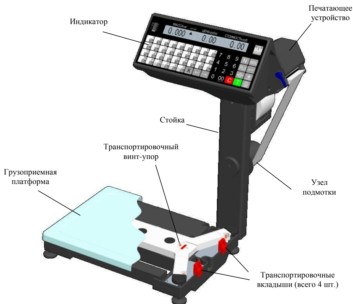
Рис. 3. Общий вид весов ВПМ_Т1
